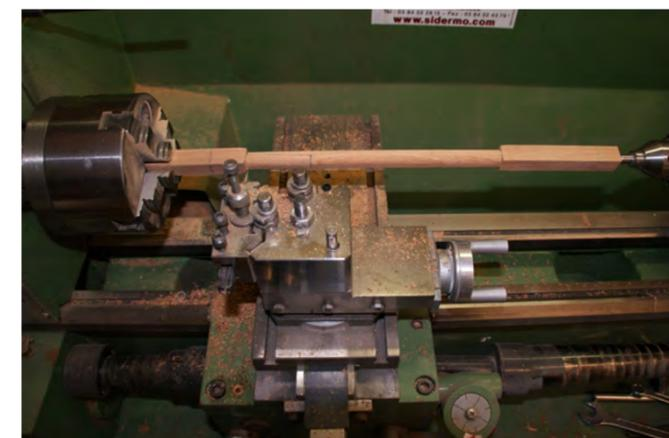
Photo n° 41: Réaliser ensuite les deux noix qui serviront à suspendre les pantoires des haubans à colonnes.
