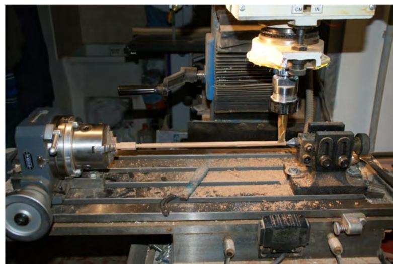
Photo n°43: Réalisation de la section octogonale.
