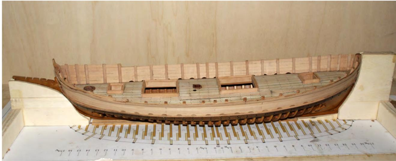
Photo n°80: Vue latérale de la coque avec le vibord terminé mais à peaufiner.
