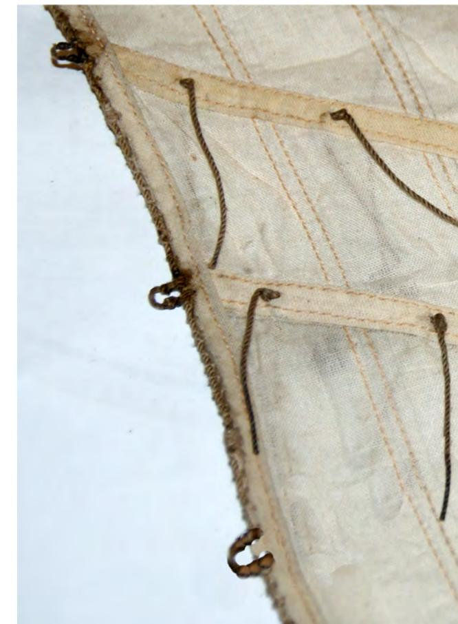
Photo n°216: Les pattes de la chute et les rabans de ris – la voile mestre avec 3 pattes (3 cargues) et la voile de trinquet avec 2 pattes (2 cargues) – les rabans de ris (145) ont un diam. de 0,70mm.
