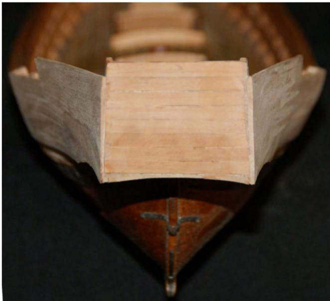
Photo n° 129: Vue de la partie externe des ailes et du tableau de poupe.
