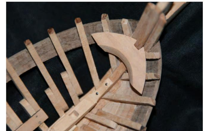
Photo n° 34: Mise en place de la guirlande de proue (25). Les encoches pour recevoir la bauquière sont à faire (une par côté). On notera l'emplanture du mât de trinquet sur la carlingue au-dessus de la quille.
