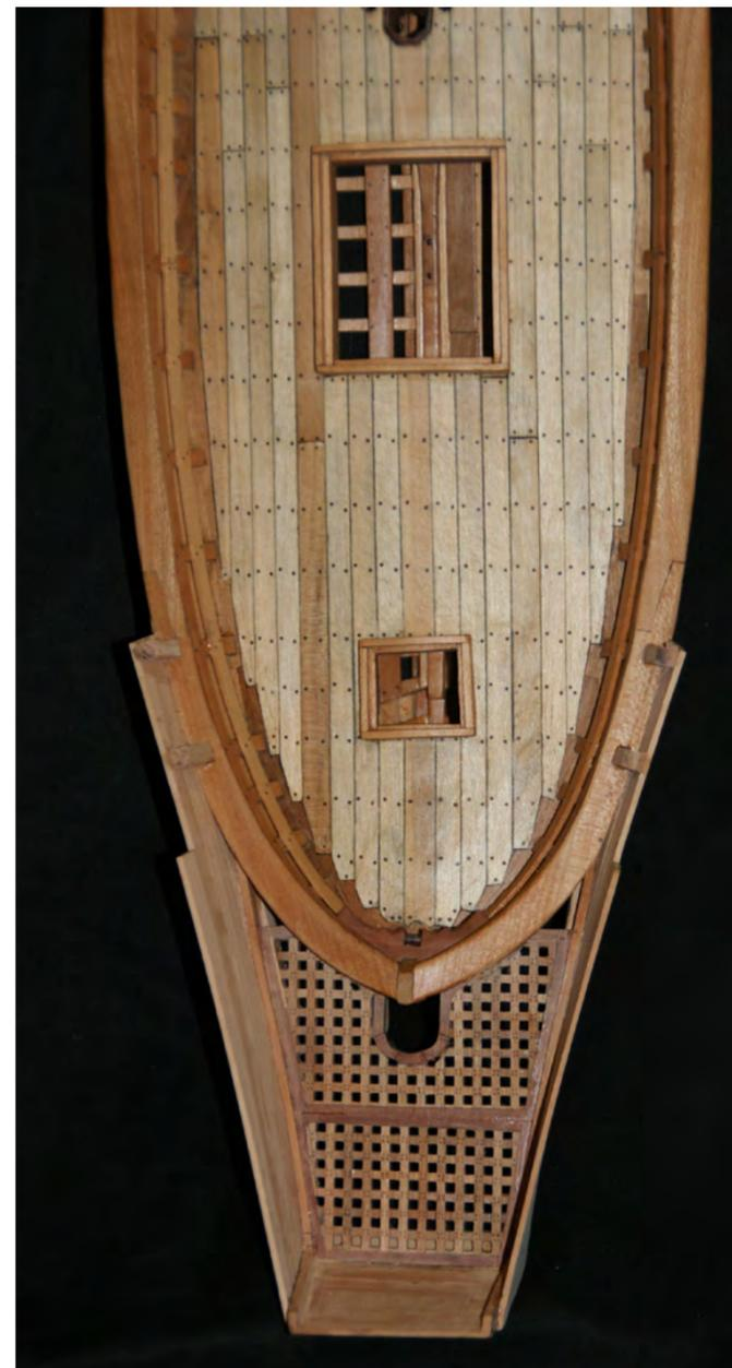
Photo n° 131: Vue du dessus de la poupe, détail de la jau-mière pour le passage du gouvernail.
