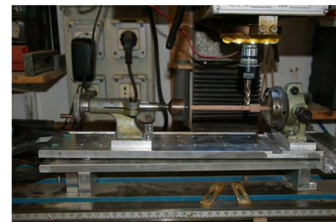
Photo n°59: Dans la deuxième phase on obtient un octogone conique correspondant au fut de la pompe. Sa fabrication s'effectue assez aisément à la fraise, à l'aide d'un plan incliné, d'un plateau diviseur et d'une contrepointe.
