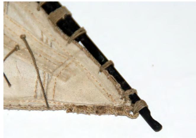
Photo n°219: Liure de la voile sur le quart de l'antenne au point d'amure.
