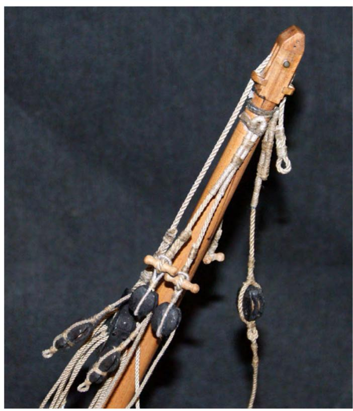
Photo n°222: Détail des pantoires - le capelage est identique pour les deux mâts - seule la dimension varie. Pantoires 108 et 112 (mestre).
