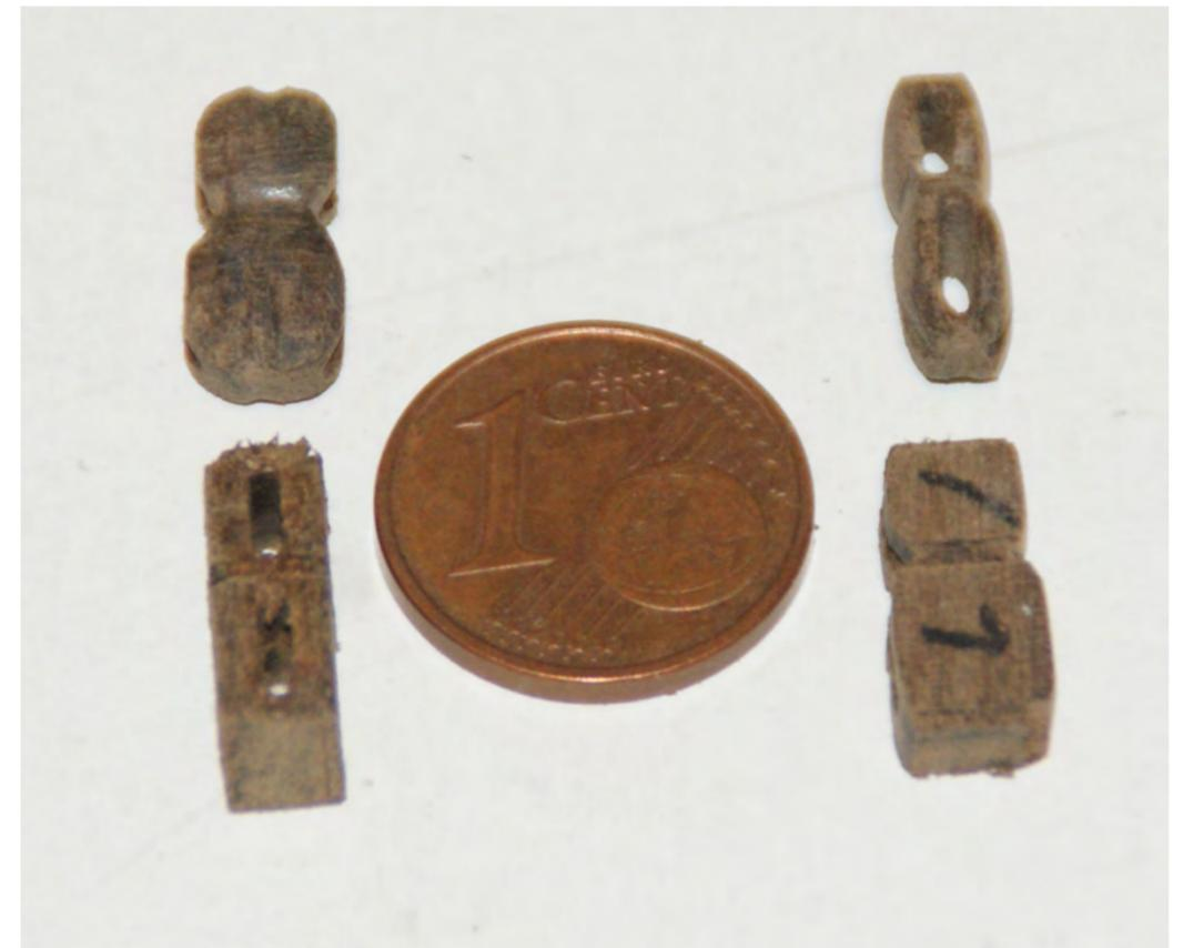
Photo n°194: Poulies façonnées prêtes à recevoir les réas.
