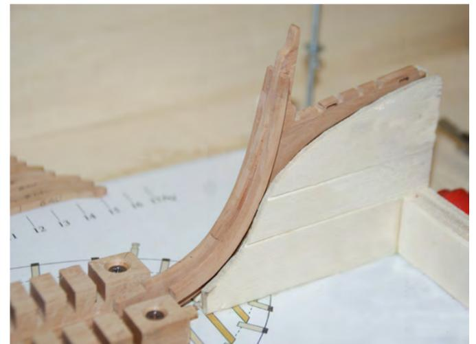
Photo n° 13: Après la râblure il faut poser les apôtres (52) de la proue, un de chaque côté. Voir la planche 3 pour les cotes.
