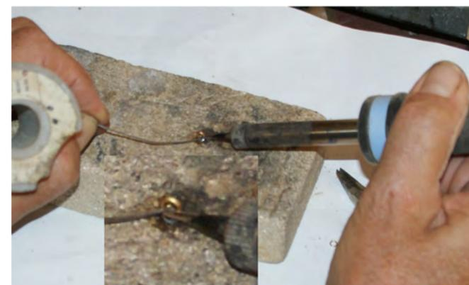
Photo n°178: Achèvement du piton. Glisser l'œillet dans la tige, insérer l'ensemble sur ce pain ignifuge d'orfèvre, qui est souple, et souder à étain. Le pain ignifuge s'appelle Magnesia Soldering Block --. On peut l'acheter aux USA: <http://www.ottofrei.com/>.
