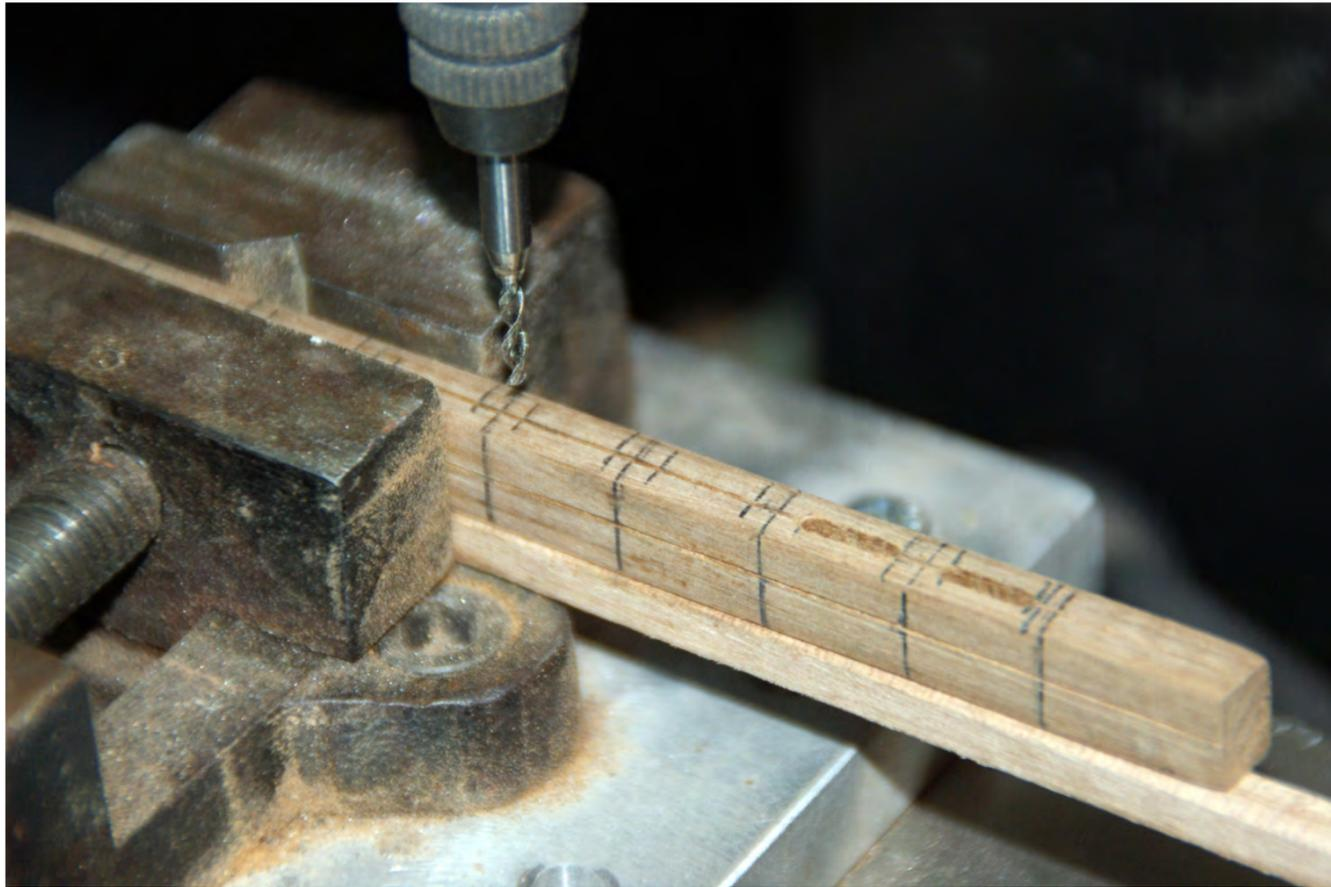
Photo n°200: Quatrième phase: perçage du corps de la poulie avec l'outil n°3, une fraise.
