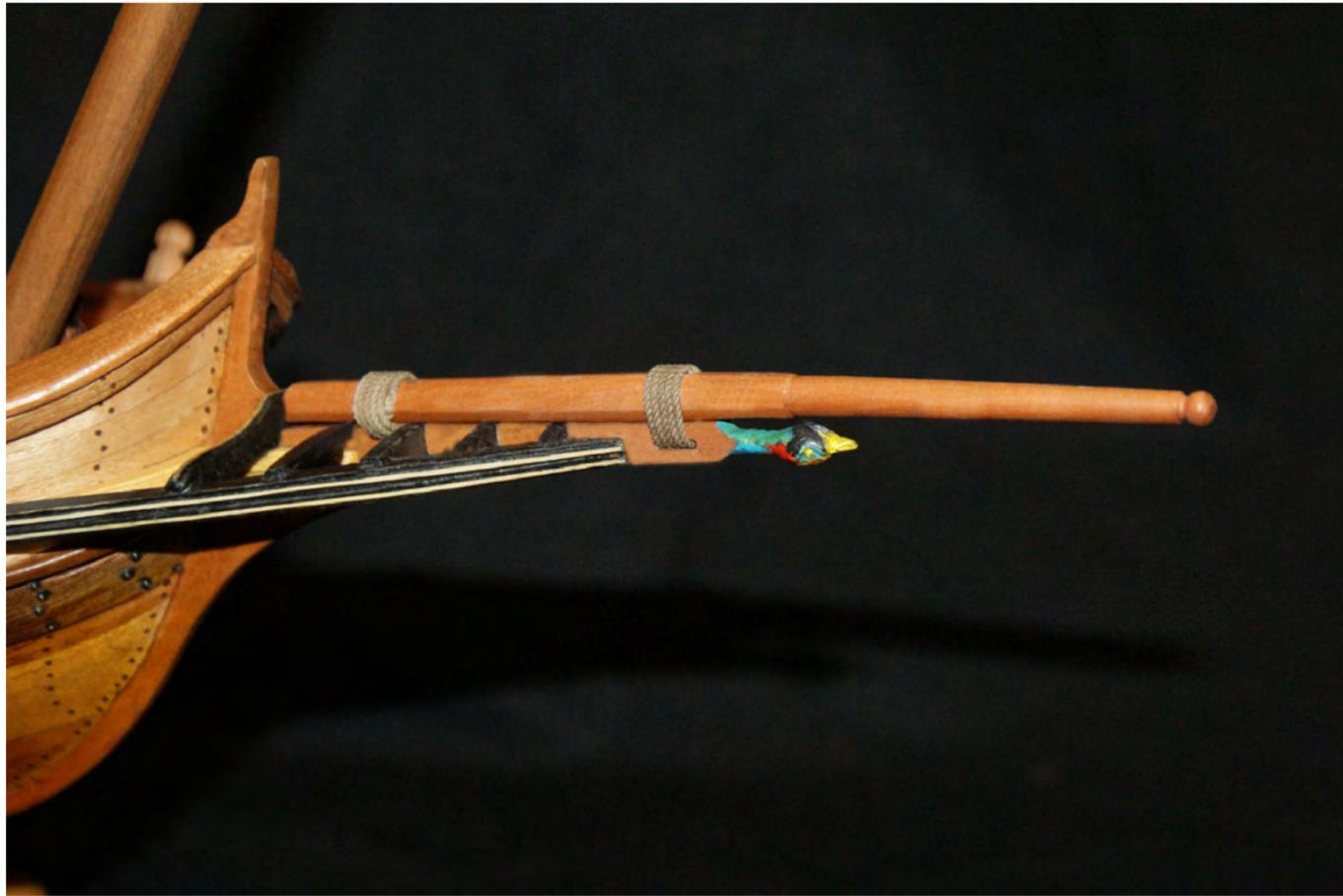
Photo n°172: Le berthelot en œuvre sur l'éperon, les liures (corde de diam. 1,00mm) le retiennent à l'éperon.
