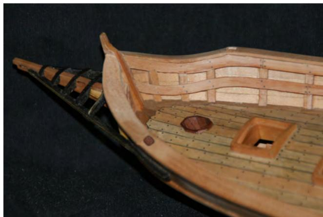
Photo n° 107: Détail du plat-bord de l'avant. Noter ses deux ouvertures carrées pour le passage des montants faisant fonction de bittes ou appotureaux.
