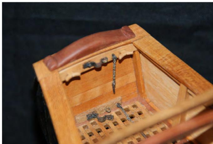
Photo n° 136: Détail de l'intérieur du tableau, accastillage nécessaire à la fixation du mât de pavillon: deux colliers montés sur charnières (73) et fermetures par pitons dans un anneau, chaînettes de retenue pour les pitons, deux petits taquets pour les manœuvres du pavillon.
