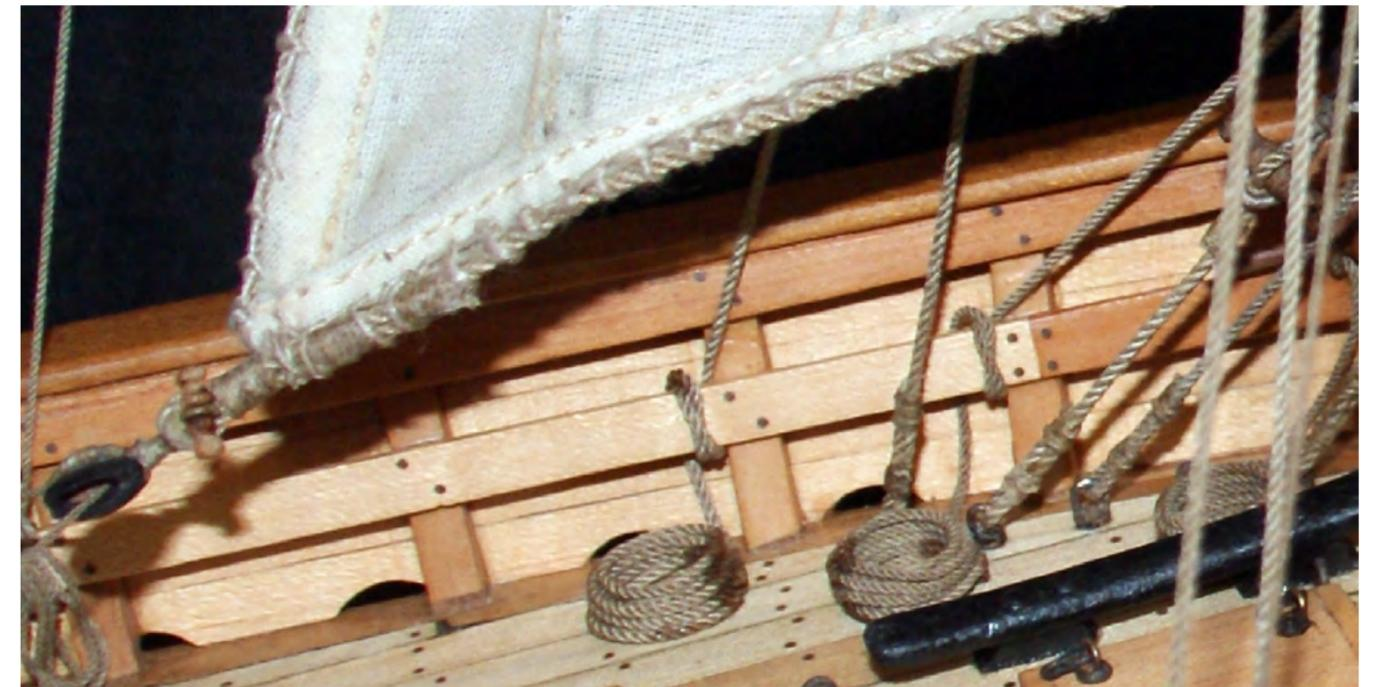
Photo n°241: Détail de l'écoute de trinquet: ici elle part du taquet central, passe par la poulie du point d'écoute et revient sur la lisse de vibord. La position d'amarrage sur ces points n'est pas obligatoire, elle peut changer selon la position de la voile et son réglage en fonction du vent.
