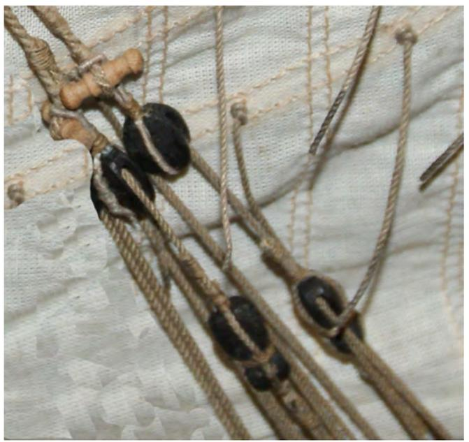
Photo n°223: Détail des dormants (109) et (113) du palan simple.
