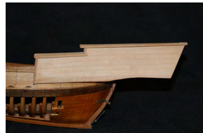
Photo n° 132: La *cadrega*: partie extérieure des ailes; le plat-bord est en place.
