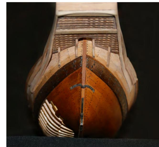
Photo n° 123: Vue de bas en haut. Les courbâtons, les longerons de support des ailes et la traverse.
