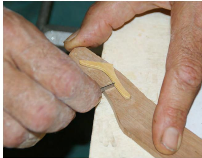
Photo n. 90: Pour réaliser au mieux la moulure je colle la pièce sur un support en bois parfaitement lisse pour garantir le bon glissement de l'outil. Une fois le travail terminé je détache le courbaton du support avec un solvant (l'acétone dissout toutes les colles, même la colle cyano).
