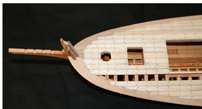
Photo n° 68: Bordage du pont à la proue - étambrai du mât de trinquet et petite écouteille.
