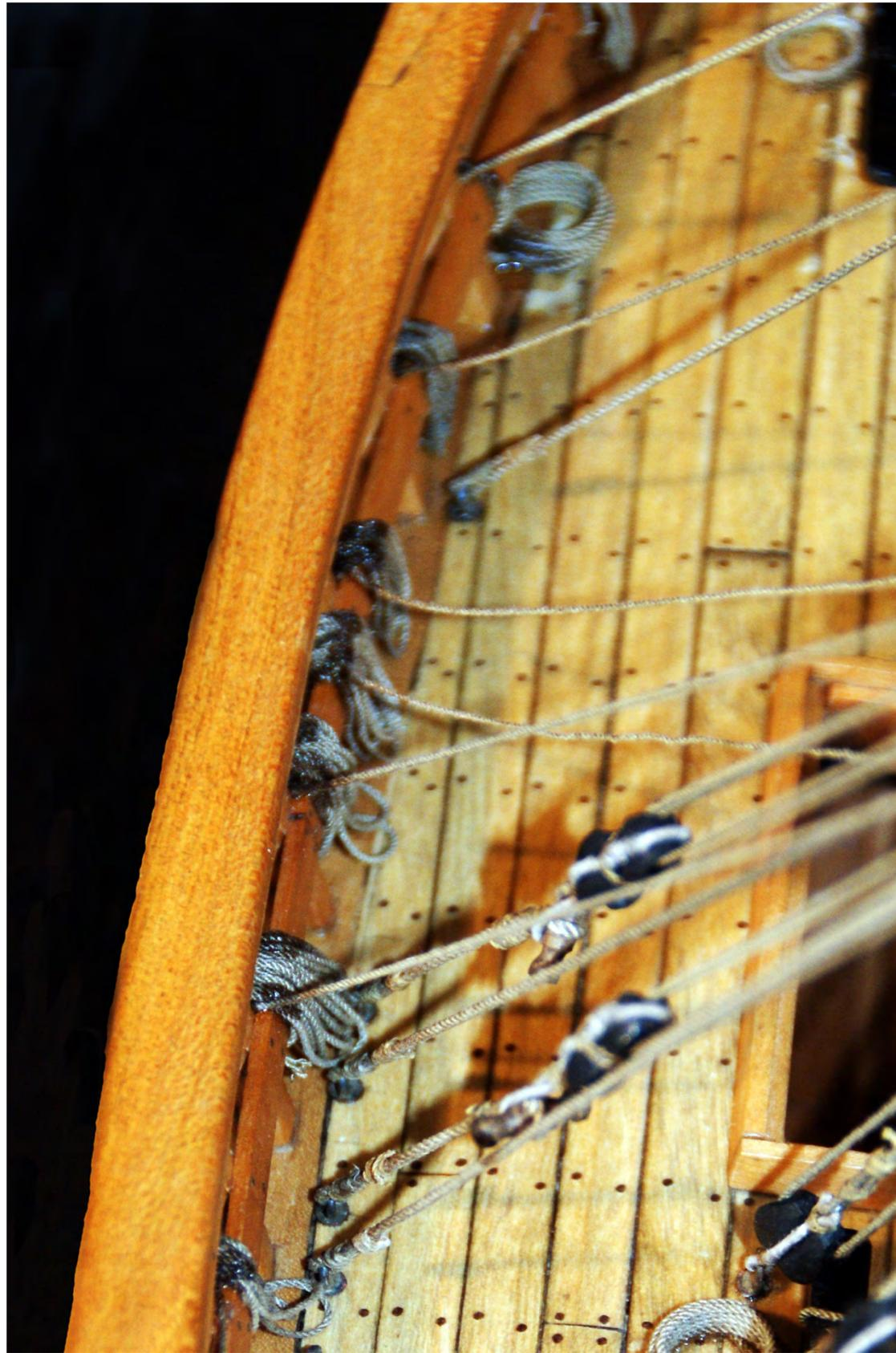
Photo n°269: Détail des arrêts des cargues (131), (132) et (133) sur la lisse de vibord (39).
