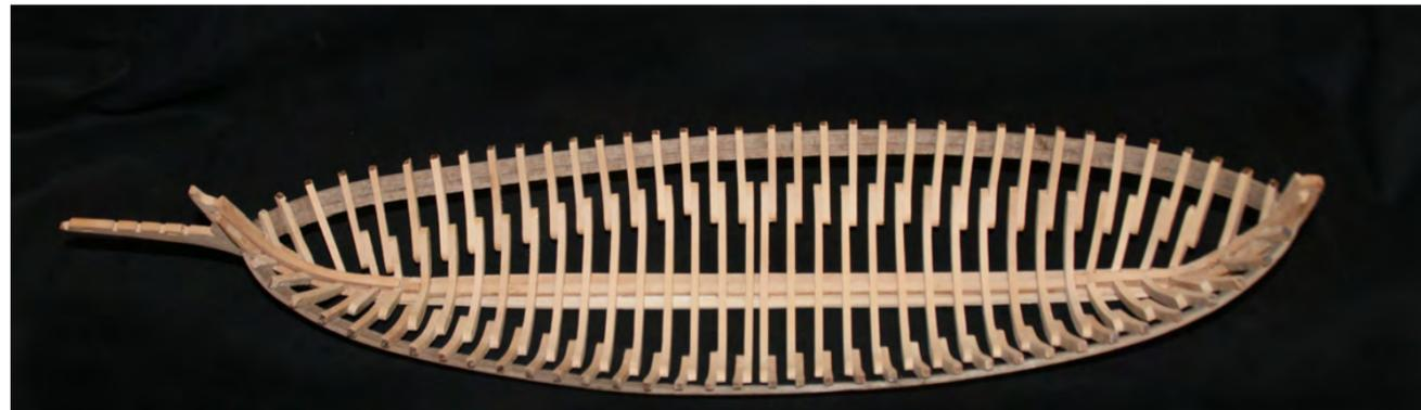
Photo n° 29: Les préceintes extérieures (58) et la carlingue vaigrage de fond (24) sont en place. L'ossature est maintenant prête à recevoir le
