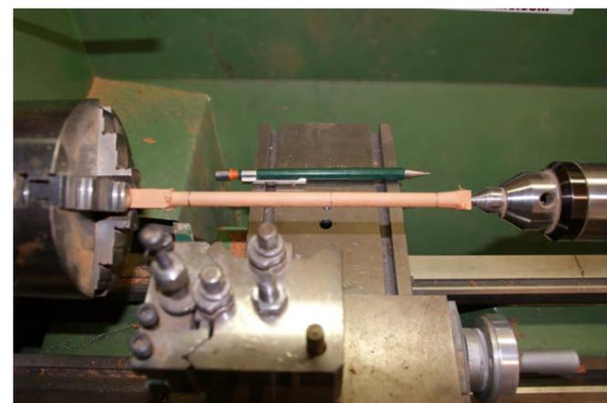
Photo n° 163: Le berthelot sur le tour mécanique. Pour le réaliser, il vous faudra un carré de 6x6mm et vous reporter à la planche n°16 pour ses dimensions.
