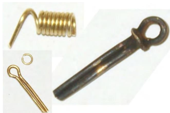
Photo n°179. Les 3 éléments et le piton fini et noirci. Nous passons maintenant à la phase trois et la réalisation des différents types de poulies du gréement.
