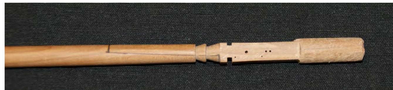
Photo n° 46: Le calcet tourné sur l'autre face montre les deux rainures, le trou pour le passage du pivot du réa et deux trous supplémentaires utilisés en cas de nécessité. Ces derniers ne sont pas grésés dans le modèle.
