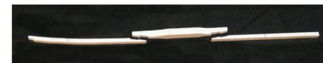
Photo n° 23: On distingue latéralement les trois pièces de la carlingue, au centre la pièce qui reçoit l'emplanture de l'arbre mestre.
