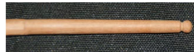
Photo n°170: Détails du berthelot: la tête tronc-conique et la boule terminal. Sur la photo on voit à peine sa courbure.
