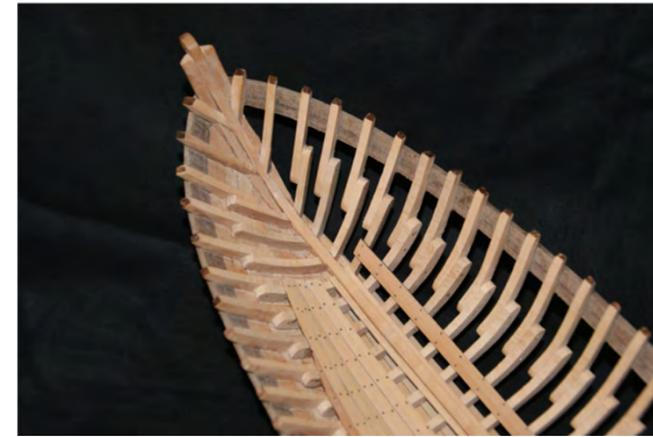
Photo n° 3: Les couples de la proue, le vaigrage de fond et le bordage.
