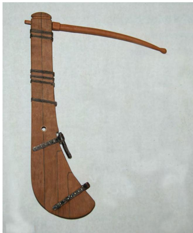
Photo n° 118: Le gouvernail terminé, la barre mise en place, un trou pour passer la brague du gouvernail, en dessous l'aiguillot et plus bas encore le femelot.
