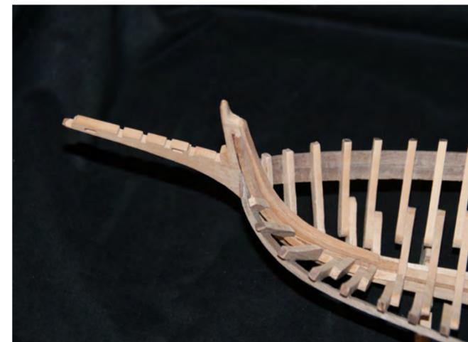
Photo n° 21: Pour le montage des membrures dévoyées de proue et de poupe l'angle d'équerrage doit être réalisé au pied de la varangue (ou fourcat selon la position du couple) et les allonges doivent suivre la courbure de la coque.
