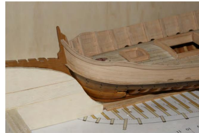
Photo n° 83: Détail de la proue avec le vibord terminé et le bordage de la lisse de pavois. Noter l'évolution des virures du pavois.
