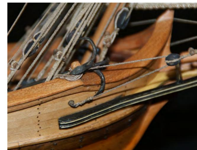
Photo n°283: L'ancre d'affourche de proue sur le plat bord.
