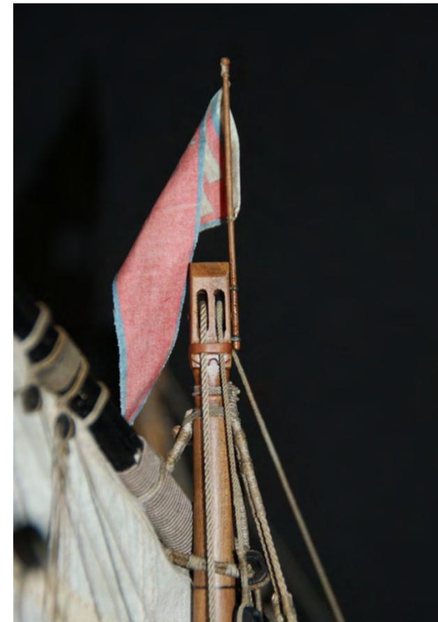
Photo n°252: Détail de la tête à calcet du mât de mestre avec ses deux réas : passages du flon de drisse et de la balancine.
