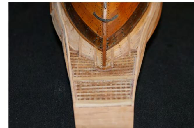
Photo n° 122: Vue dessous-dessus de la poupe. On visualise les longerons et quatre barrotins qui soutiennent les caillebotis ainsi qu'une traverse en dessous.
