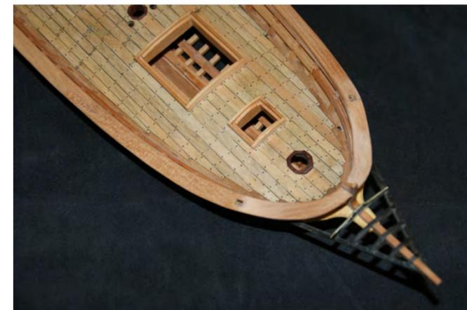
Photo n° 104: Vue de l'avant le plat-bord (61) installé. Dimensions du plat-bord: mm. 1,5 x 8.
