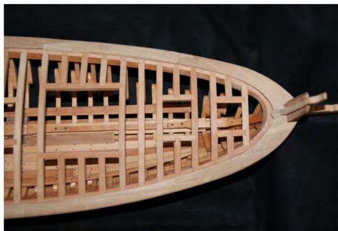
Photo n° 37: Gouttière - 12 x 3 mm. - épaisseur à l'extérieur 3,5 mm..
