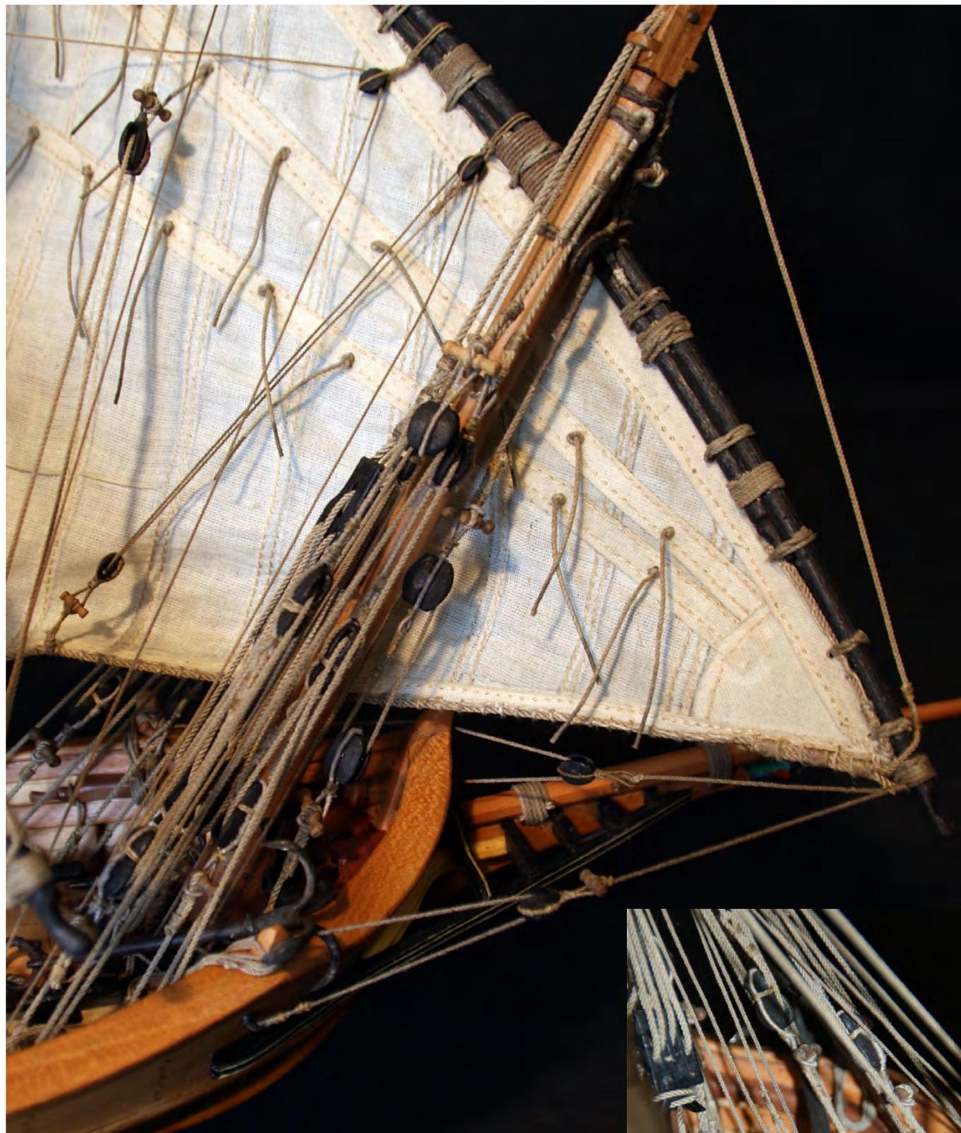
Photo n°233: Vue complète de la manœuvre de trinquet.
