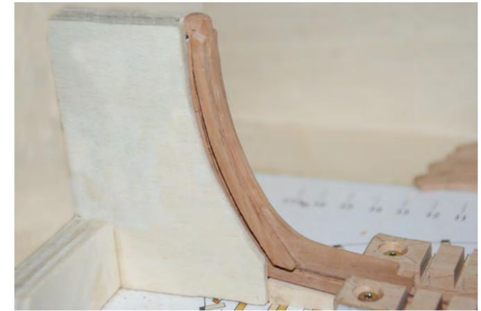
Photo n° 14: Pose des apôtres de la poupe (53). Voir la planche 3 pour les cotes.
