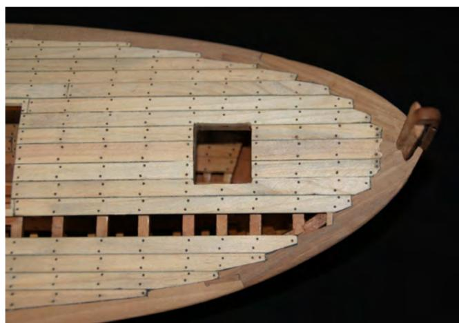
Photo n° 70: Bordage du pont, vue de la poupe et de la petite écouteille. Le cloutage du pont est à Ø 0.6 mm.
