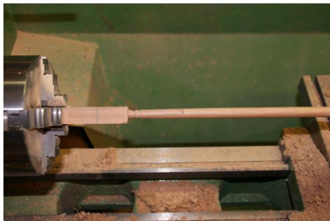
Photo n°42: Une fois les noix réalisées, on passe à la partie interne de l'arbre de section octogonale et au tenon carré.
