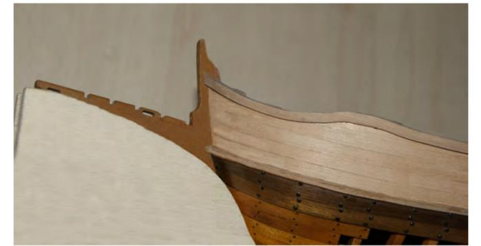
Photo n° 86: Détail de la proue avec le vibord terminé et le bordage de la lisse de pavois. Remarquer l'accentuation de la courbure du vibord.
