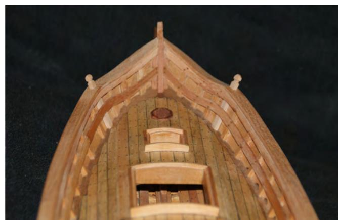
Photo n° 110: Les bittes sont fixées sur le plat-bord de l'avant. Les coins de l'arbre de trinquet (32), la petite et la grande écouteille sont en place.
