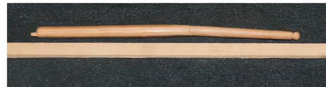
Photo n° 168: La comparaison avec une latte droite donne le degré de courbure qu'il faut donner au berthelot.
