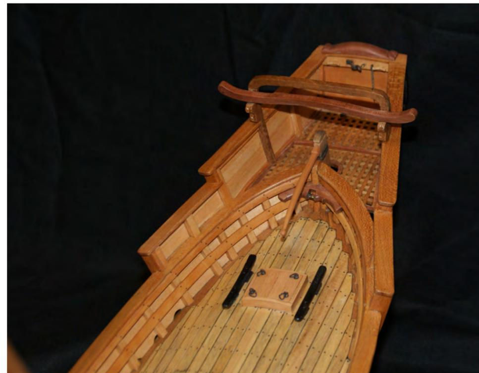
Photo n° 150: La poupe est terminée! On remarque la charpente des ailes, la barre du gouvernail, la petite écoutille de poupe avec son capot et les taquets sur les côtés.
