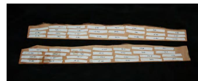
Photo n° 75: Les montants positionnés sur les planchettes prêtes à la découpe. Les mesures sont prises sur les planches 4 et 5. Comme déjà anticipé il faut couper seulement ceux dessinés avec un trait continu.
