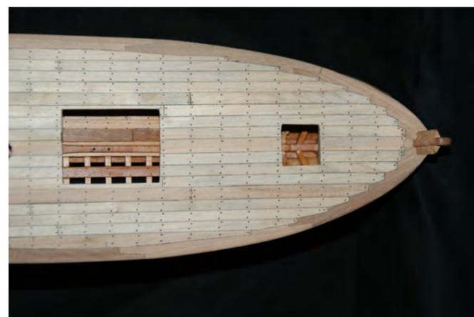
Photo n° 72: Bordage du pont terminé, vue de l'arrière.
