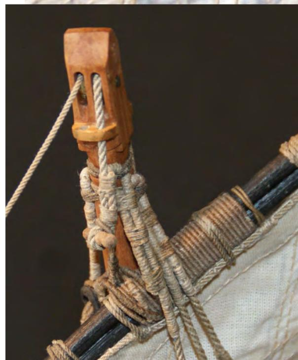
Photo n°225: Détail du grément de l'arbre de trinquet avec son hauban à colonnes et la pantoire de la candelette.
