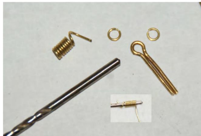
Photo n°177: Un piton, une spirale et deux œillets avec la mèche pour la réalisation de la spirale. Passons maintenant à la finition du piton.
