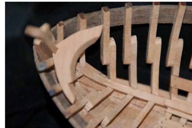
Photo n° 33: Mise en place de la guirlande de poupe (26). Sur le côté gauche de la guirlande on peut remarquer une encoche prête à recevoir la bauquière. Naturellement il y a une encoche sur chaque côté.
