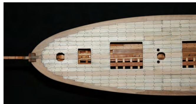
Photo n° 71: Bordage du pont terminé, vue de l'avant.
