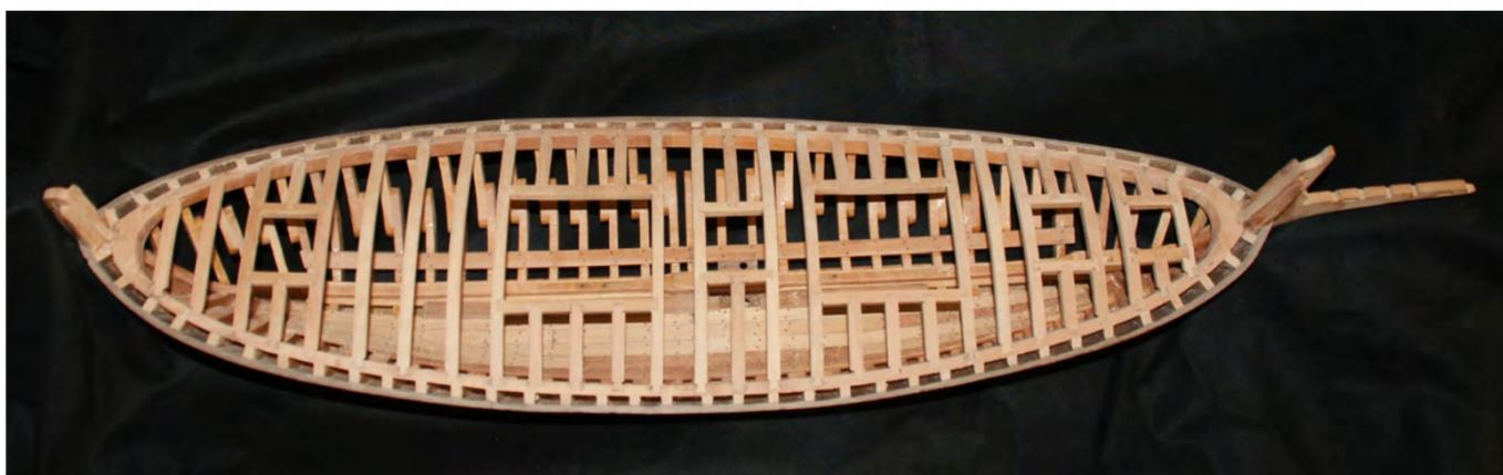
Photo n° 36: Vue complète de la structure du pont: les deux guirlandes avec les logements des bauquières, les barrots (28), les demi-barrots (28) et les ouvertures sont en place. En partant de la proue la première ouverture est prête à recevoir l'étambrai du mât de trinquet (29), la deuxième ouverture est pour la petite écoutille (36), la sixième pour une autre petite écoutille (36).
