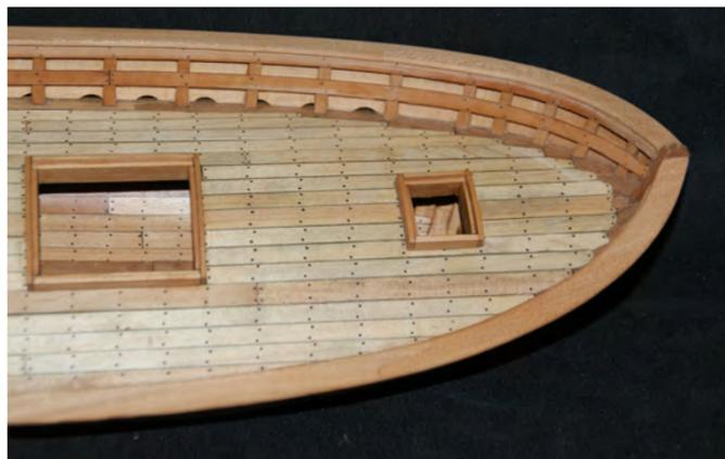
Photo n° 109: Détail de la poupe: plat-bord, lisse du pavois, lisse du vibord, grande et petite écouteille de poupe.
