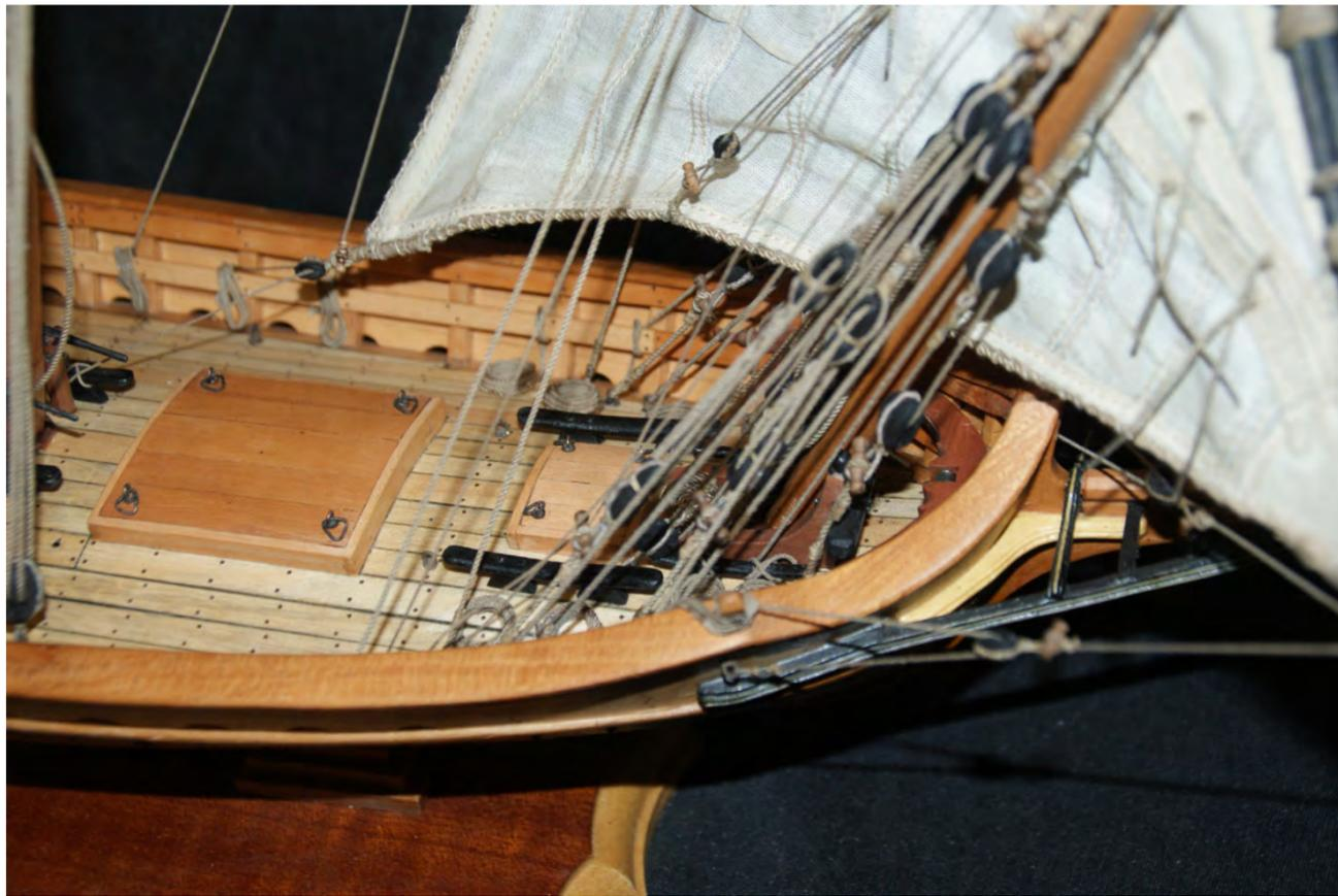
Photo n°242: L'écoute de trinquet. Détail de la poulie et de sa fixation dans la boucle du point d'écoute (noter le renfort).
