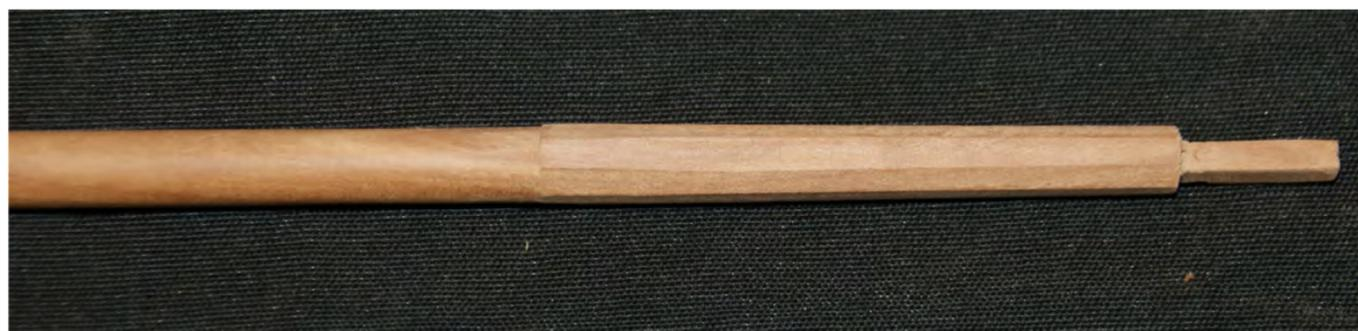
Photo n°44: La partie sous les ponts des mâts est octogonale et se termine par un tenon qui sera encastré dans l'emplanture de la carlingue.
