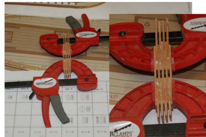
Photo n°180: La réalisation des tailles et des taillons est très semblable. Je prépare des baguettes que j'assemble à la colle en laissant du vide pour le passage des réas dans les mortaises. A l'origine ces poulies étaient fabriquées en bois d'orme.
