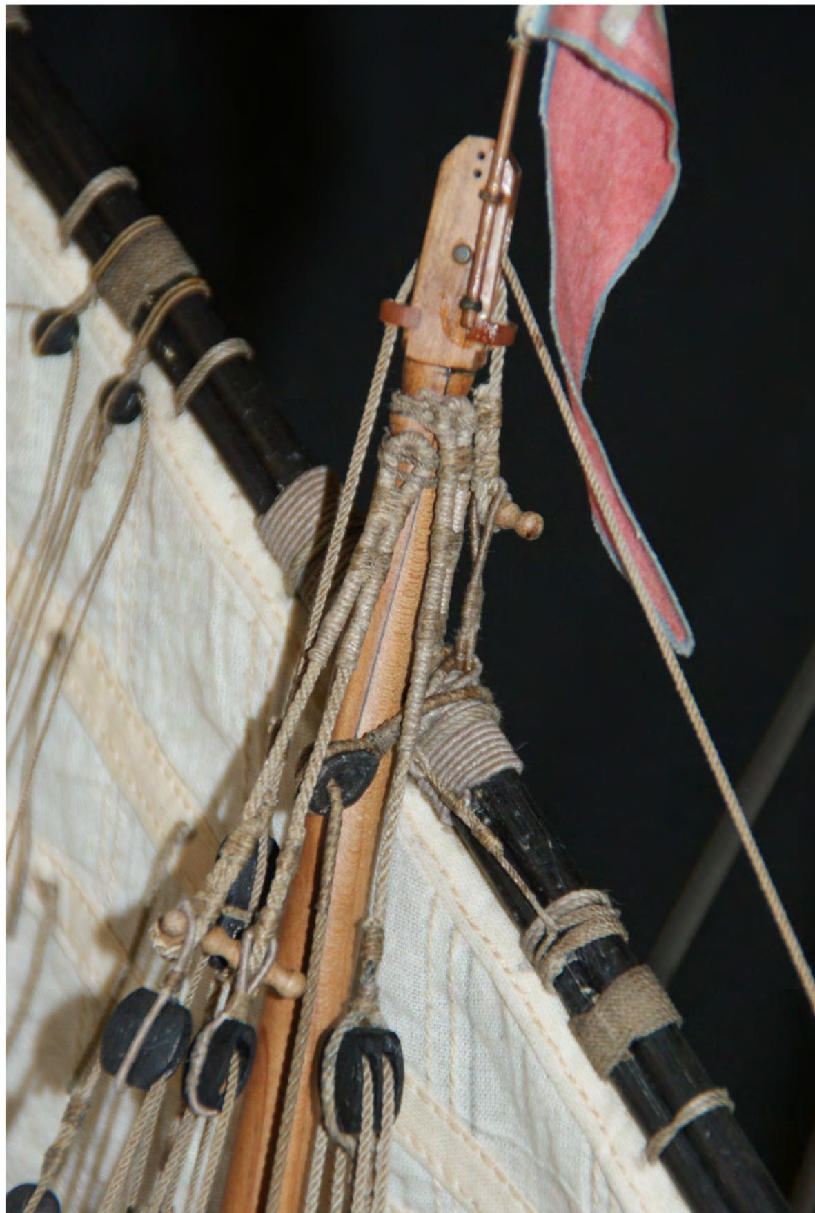
Photo n°250: Détail du capelage au mât de mestre, en premier plan la pantoire de la caliorne.
