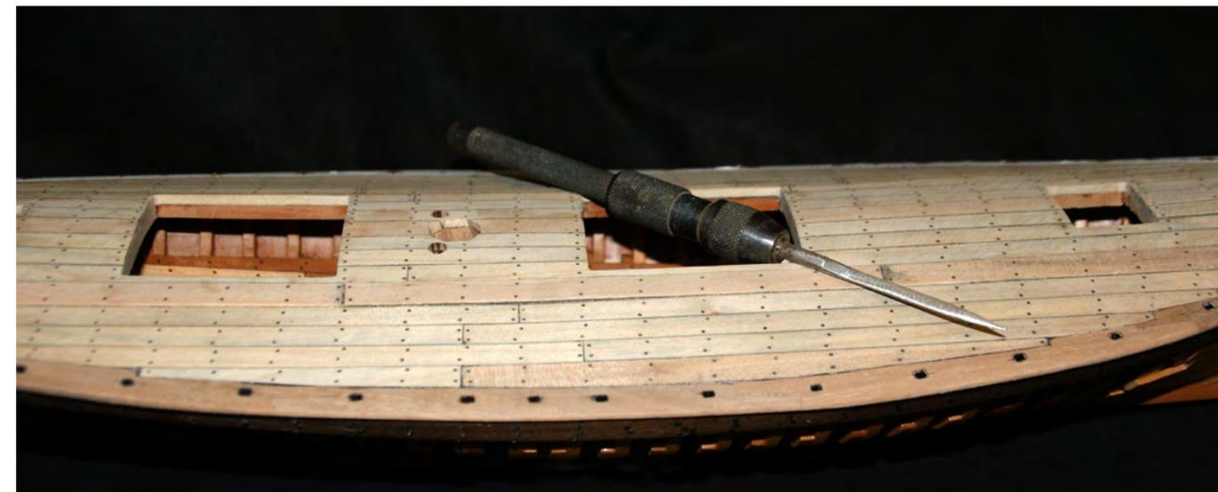
Photo n° 73: Préparation des ouvertures sur la gouttière pour y intégrer les montants (ou demi-allonges).
