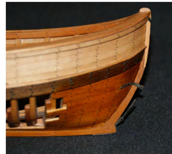
Photo n° 113: Détail de l'étambot, installation des aiguillots (18).
