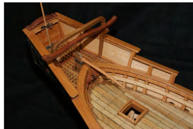
Photo n° 140: Charpente de la superstructure de la poupe complète: le haut du gouvernail passe par la jaumière, la barre est en place.
