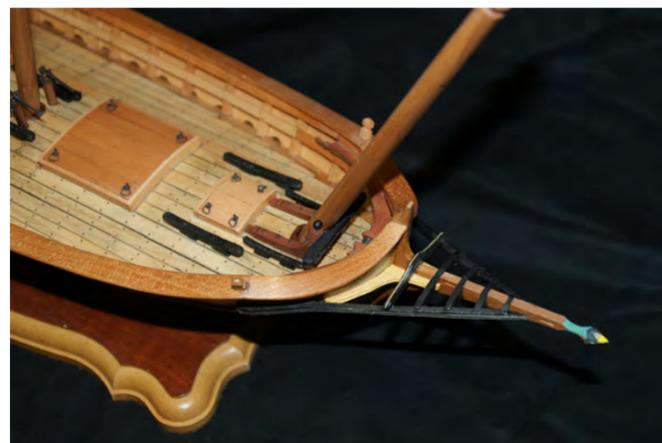
Photo n° 154: Le pont à la proue - la grande écouteille de proue et son capot refermé, l'écoutillon de proue fermé, les grands taquets et les deux petits taquets de part et d'au-
