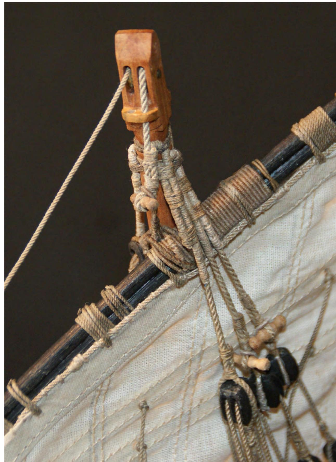
Photo n°228: Détail bâbord du calcet: le flon de drisse, la *polome*, l'aiguillette, le bragot que fait la drosse avec la bigotte ovale ou moque et la pantoire du hauban à colonnes.
