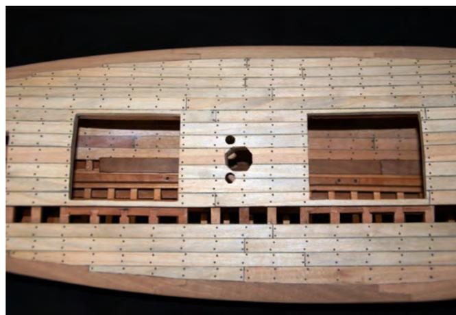
Photo n° 69: Bordage du pont, vue du centre, des deux grandes écouteilles et de l'étambrai de l'arbre mestre.
