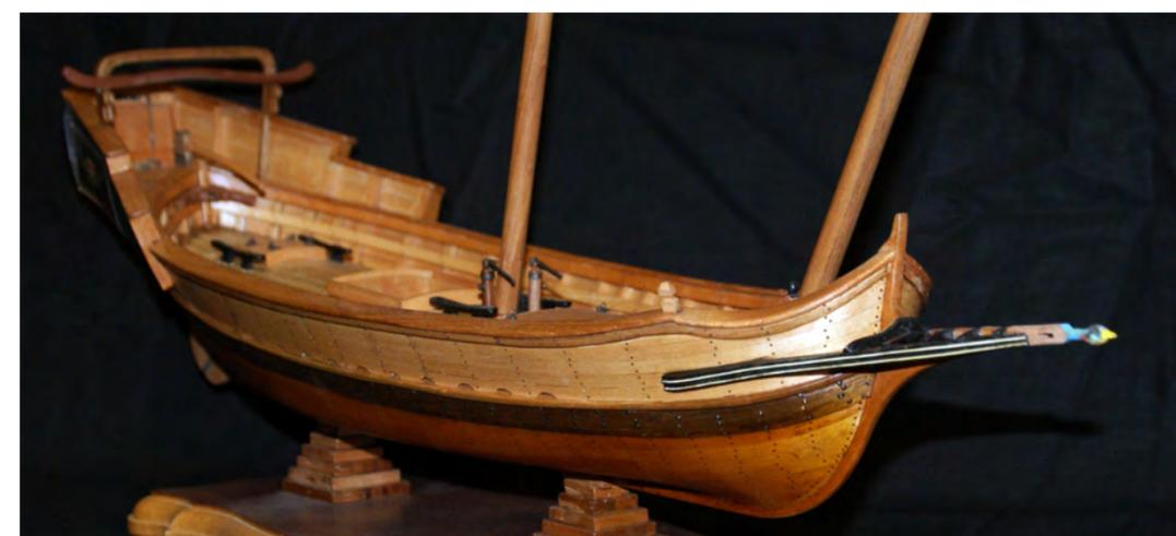
Photo n° 160: Vue latérale de la coque avec les mâts emplantés. Les chevilles à boucles pour les manœuvres ne sont pas encore emplantées.
