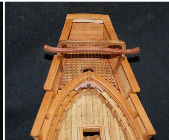
Photo n° 133: La *cadrega* presque terminée; pose de la tenaille et de la traverse des ailes.
