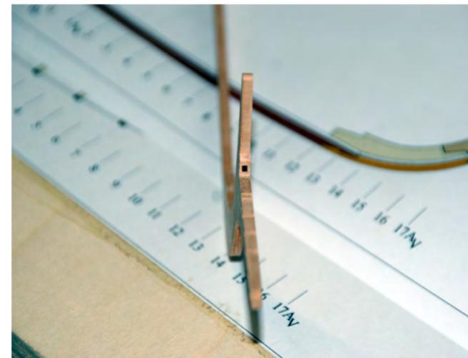
Photo n. 10: Vue frontale du taille-mer avec sa mortaise carrée, sur laquelle s'encastre le tenon du bertherlot. Une fois la quille complétée on passe à la réalisation de la râblure.
