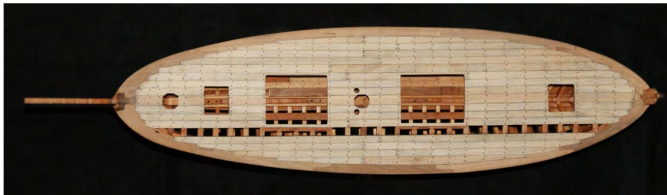
Photo n° 67: Le bordage et le cloutage du pont sont terminés. Une latte n'a pas été posée pour montrer les virures d'hi-loire – le bordage du pont est plus épais entre les virures d'hiloire (voir dessin n° 11).
