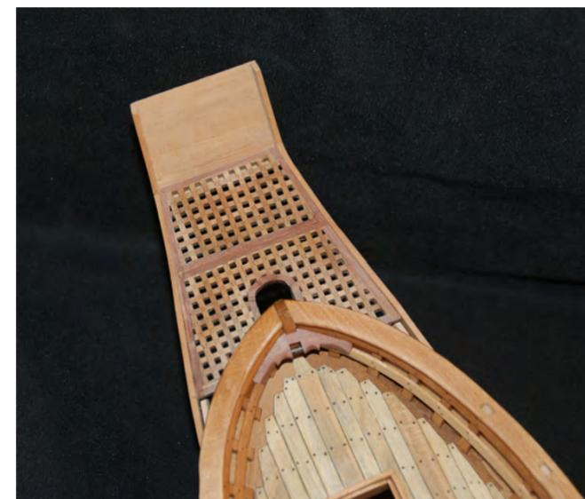
Photo n° 120: Réalisation des ailes, vue intérieure: les deux caillebotis et le tableau de poupe ont été fixés.
