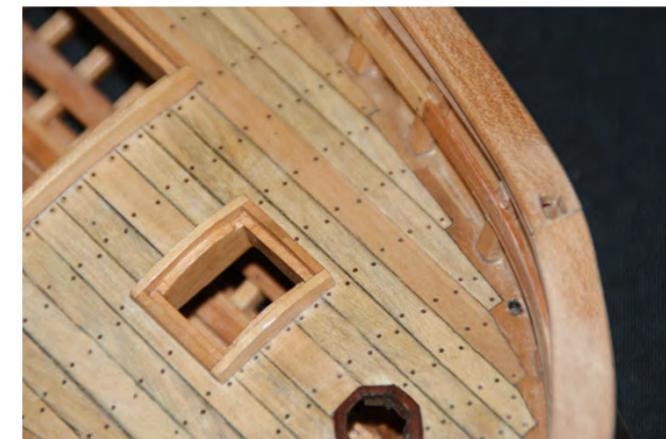
Photo n° 105: Détail du plat-bord à la proue. Noter l'ouverture carrée pour le passage de la bitte.
