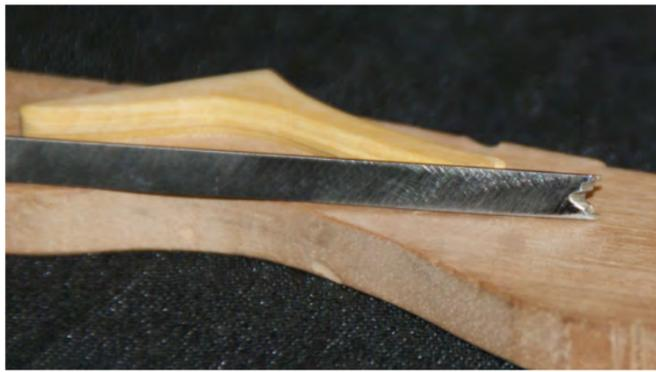
Photo n° 89: Outil pour la réalisation de ces pièces – j'utilise comme base une lame de scie pour couper des poutres en fer, que je façonne aux dimensions voulues.
