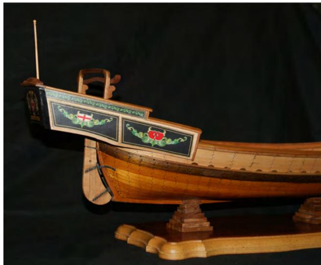
Photo n° 145: Le gouvernail est en place ainsi que le mât de pavillon, la construction de l'arrière est terminée.
