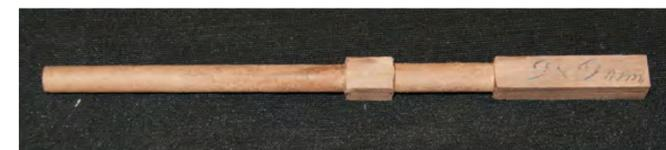
Photo n°58: On commence par façonner la pièce au tour. La longueur de la pièce est en fonction du dessin. Vous pouvez conserver les cotes de mes planches et suivre mes schémas n°10 et n°11 ou choisir une découpe de votre choix.
