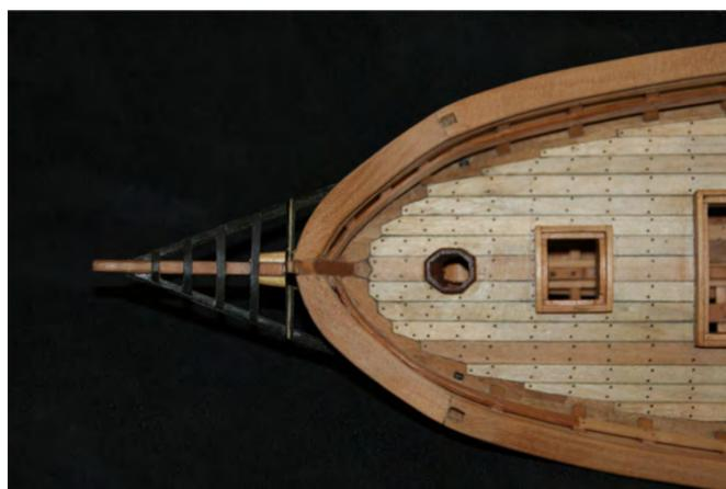
Photo n° 108: La vue du haut de l'avant montre les trous pour les bittes percés sur le plat-bord, l'éperon complété, les coins de l'arbre de trinquet (32), la petite écouteille et partie de la grande écouteille de la poupe.
