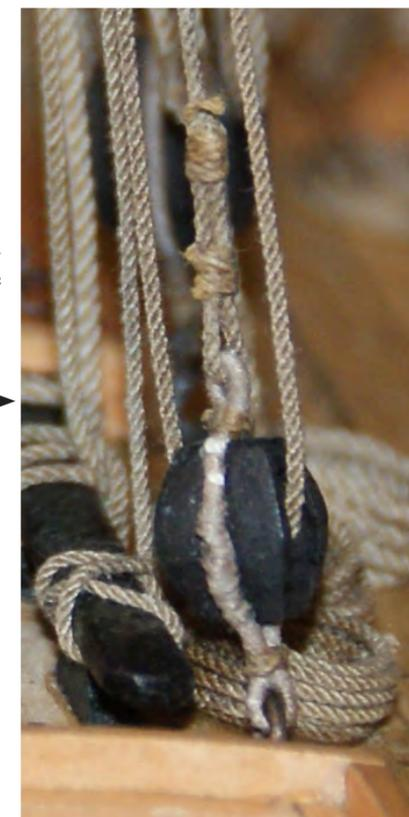
Photo n°231: La balancine du quart (140) permet de contrôler l'inclinaison de l'antenne par rapport au mât. Elle est capelée sur l'extrémité du quart, passe par une mortaise et un réa dans le calcet et estrope une poulie à violon. Cette
