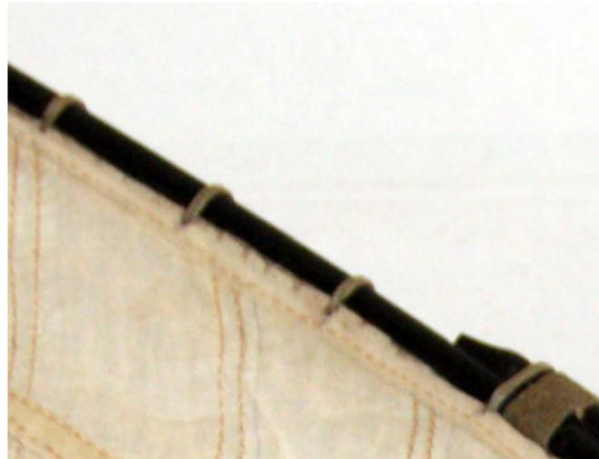
Photo n°218: La voile est enverguée sur l'antenne par simple liure.
