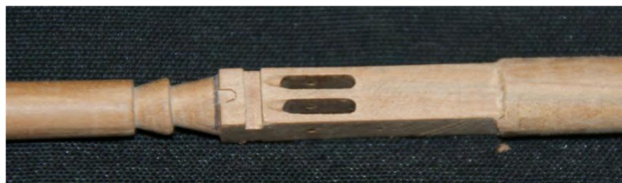
Photo n° 45: Dans la quatrième phase, on réalise la tête à calcet qui est de section rectangulaire, les deux rainures nécessaires à fixer les siones pour le passage des amans et les deux mortaises pour l'insertion des réas. Les poulies étaient réalisées en bois d'olivier.
