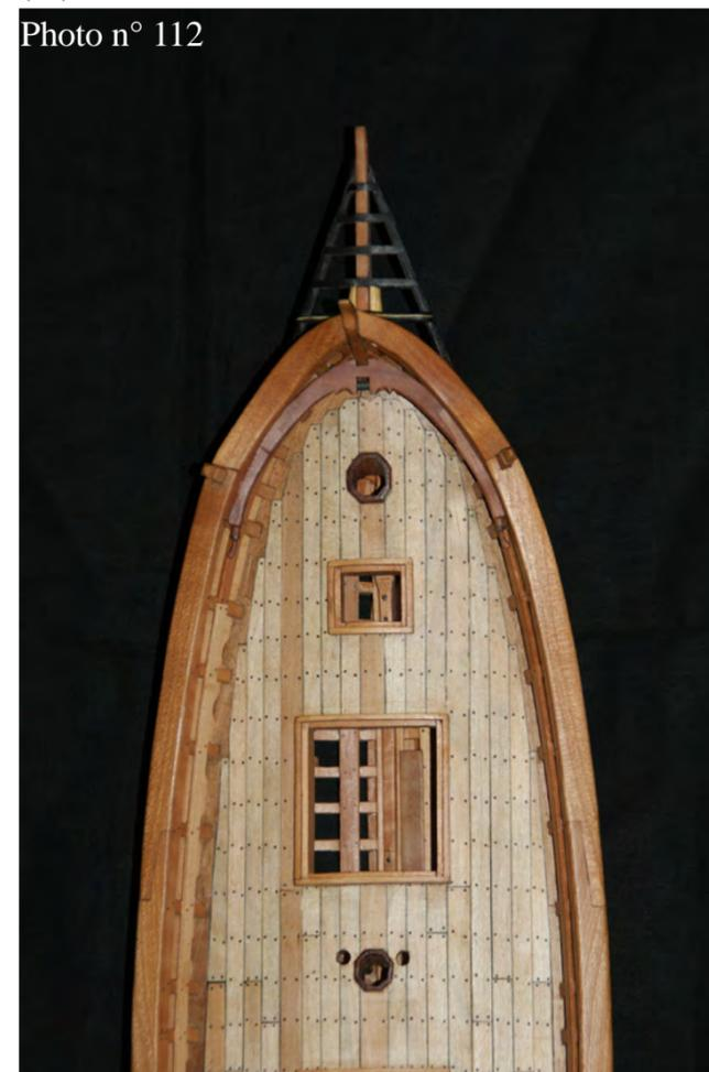
Photo n° 112: Vue du dessus. Eperon avec les herpes, les bittes du plat-bord, la guirlande de poupe (54), le passage du mât de trinquet (32), l'écouteille et la grande écouteille de poupe, le passage de l'arbre mestre (31).
