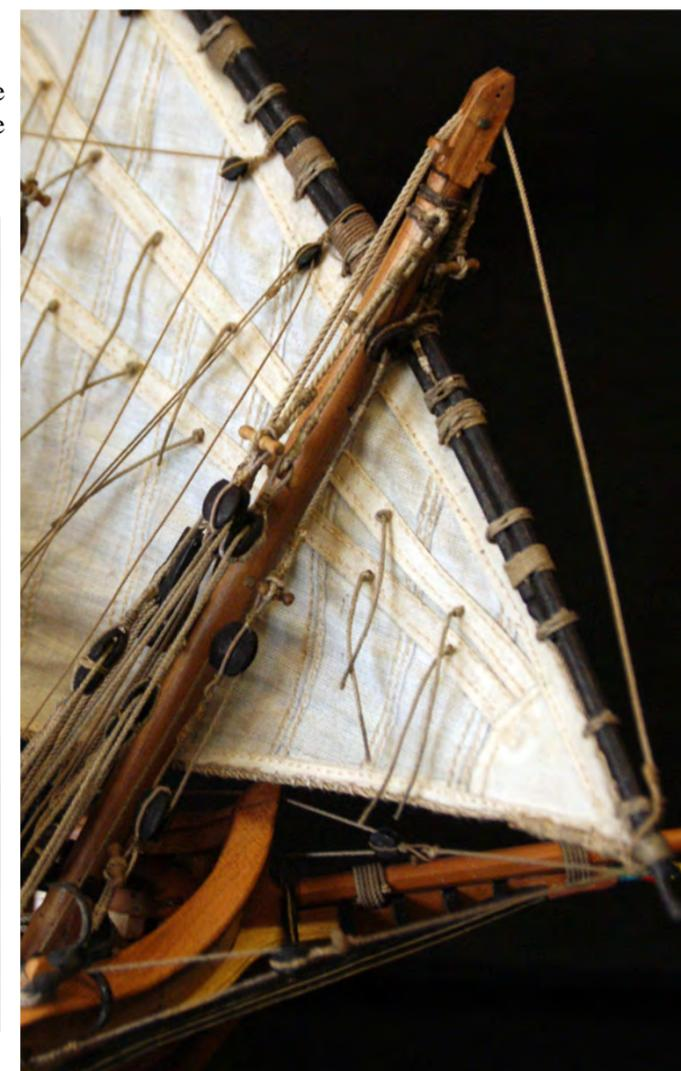
poulie à violon fait palan avec la poulie simple estropée sur à un piton au pied du mât. Le palan s'amarre sur une virure du pavois.
