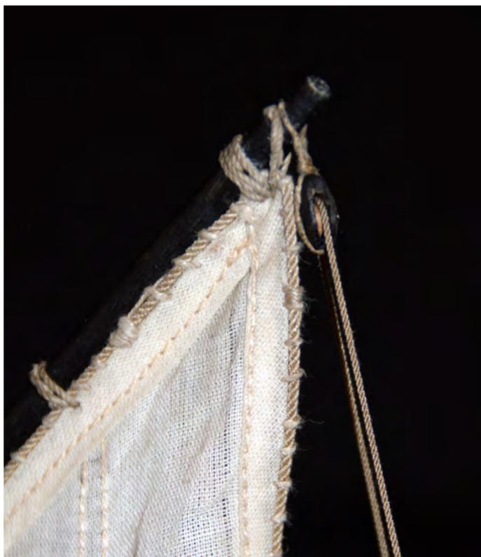
Photo n. 266a: Détail de la poulie encoquée au bout de l'antenne de mestre.
