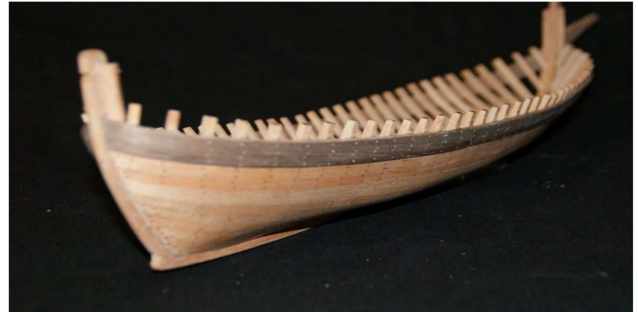
Photo n° 32: Bordage terminé Bordage extérieur (64): 1,5 x 5 mm
