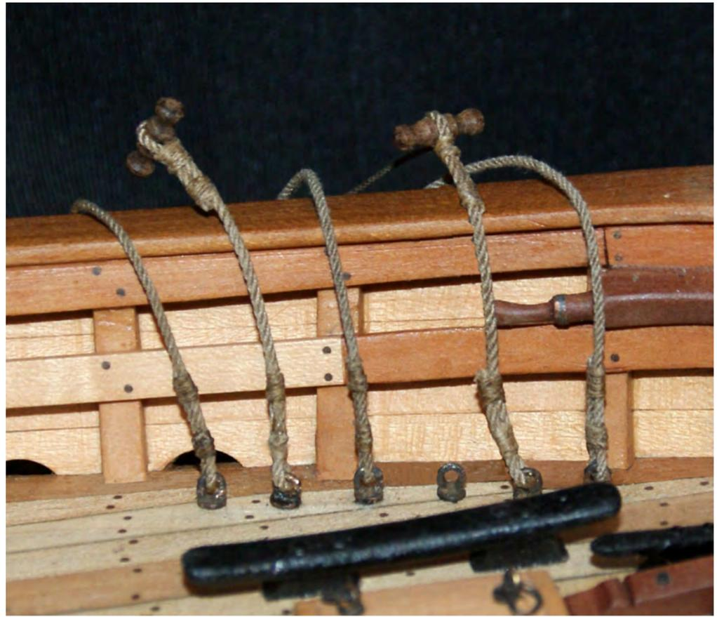
Photo n°224: Détail des bosses inférieures (111). Elles sont maillées d'un côté à l'aide d'un quinçonneau et de l'autre par une boucle dans un piton fixé au pont.
