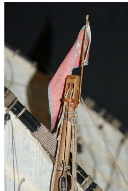
Photo n°258: Vue rapprochée de la tête à calcet avec passage (à tribord) de la balancine qui termine en estropant une poulie à violon.
