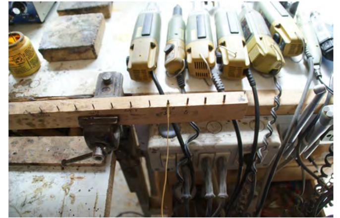
Photo n°176: Le piron en cours d'exécution. Une fois le fil replié autour d'une tige de diamètre adapté, il est partiellement prêt.
