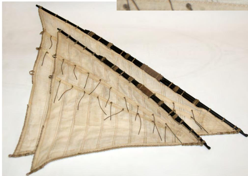
Photo n°221: Les deux voiles enverguées sur leurs antennes. Remarquer leur différence de taille et le nombre de pattes sur la chute.
