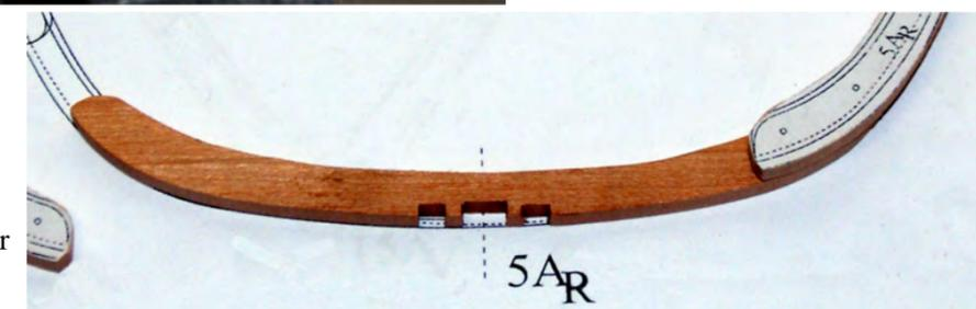
Photo n°18a: Couples assemblés – noter les entailles pour les anguillers.
