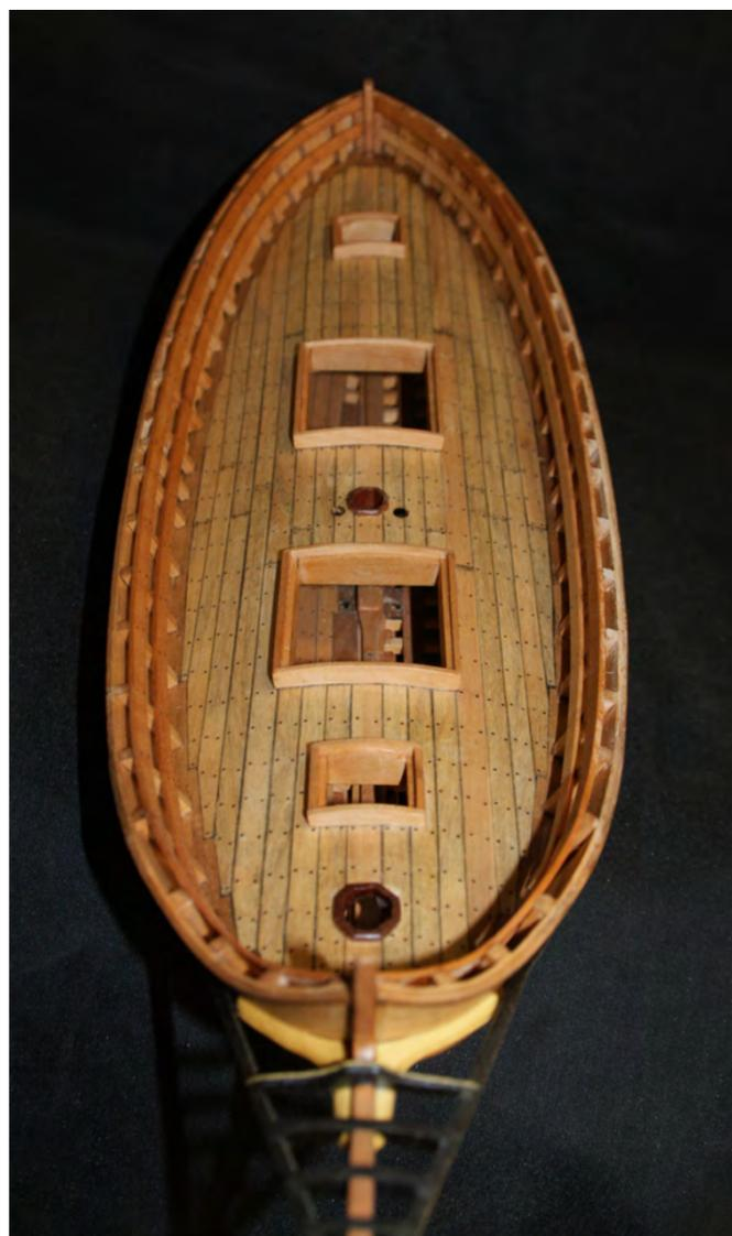
Photo n° 101: Vue du pont et de l'éperon. Le plat-bord sera posé ensuite.
