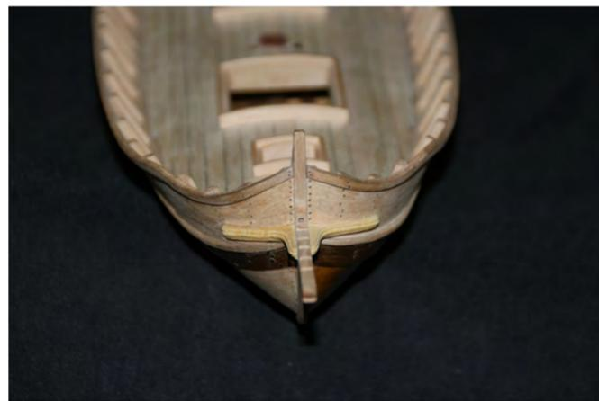
Photo n° 92: Vue frontale des courbatons fixés sur la coque – on peut commencer l'éperon et sa herpe. Les cotes de la flèche: 3x2 mm.
