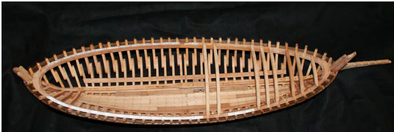
Photo n° 35: Les deux guirlandes, la bauquière (27) et quelques barrots mis en place.
