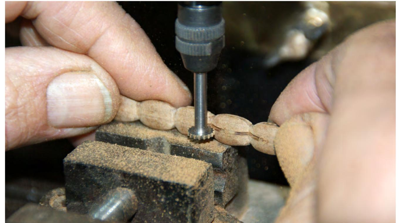
Photo n°203: Dernière phase; la fraise n°4 façonne les saignées qui logeront des estropes.
